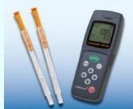
調理場内の設置機器や調理器具、食器、手指等の汚れ度を、10秒で測定できる機械です。その場で衛生状態の指導が容易に出来ます。
