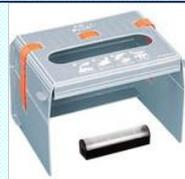
専用ローションを汚れにみたく手に塗り込んだ後、手洗いをして紫外線ライトを当てると、洗い残しの部分が発光します。洗い残し部分がすぐに判るので、手洗い指導が手軽に出来ます。
