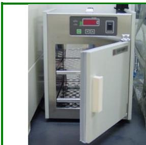
細菌や真菌類の培地を培養するのに使用します。温度調節が可能で、培地を重ねて培養できるので寒天培地やフードスタンプ、ペトリフィルム、手形培地等、どんな形態の培地にも適します。
